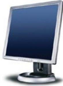
Les Afficheurs à Cristaux Liquides, **ACL**, ou écrans plats, (anglais **LCD**, Liquid Crystal Display) sont en train de remplacer les écrans CRT.
