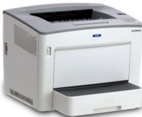
L'impression sur imprimante laser est réalisée avec une grande précision. L'encre solide presque réduite à l'état de poussière est attirée sur un bloc photorécepteur sensibilisé par un rayon laser. L'encre est alors déposée sur le support d'impression puis passée dans un four afin d'être fixée.
