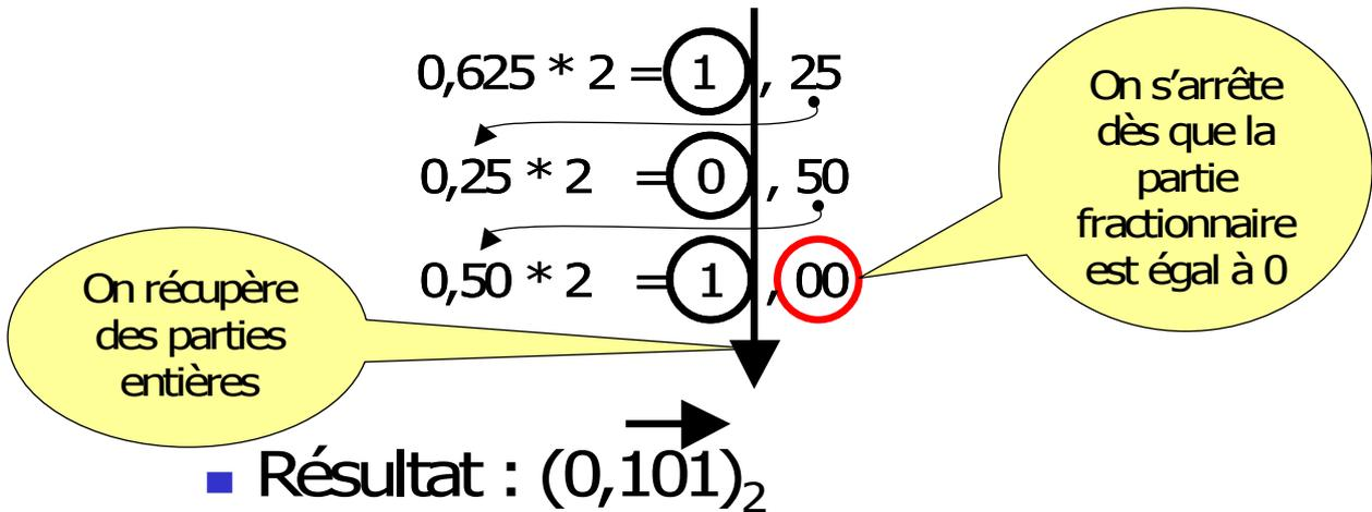
Figure 3 - conversion de la partie fractionnaire (exemple décimal vers binaire)
