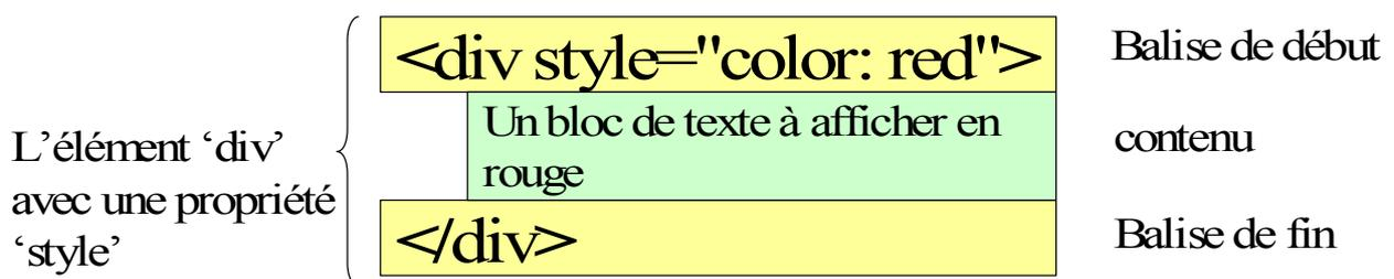
Figure 2 : un élément : une balise de début, une balise de fin et entre les 2, le contenu de cet élément
